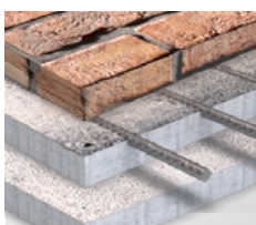
Beton, beton zbrojony, cegła
