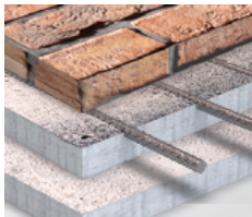
Beton, beton zbrojony, cegła
